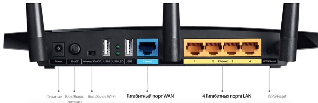
Рисунок 2. Задняя панель маршрутизатора
